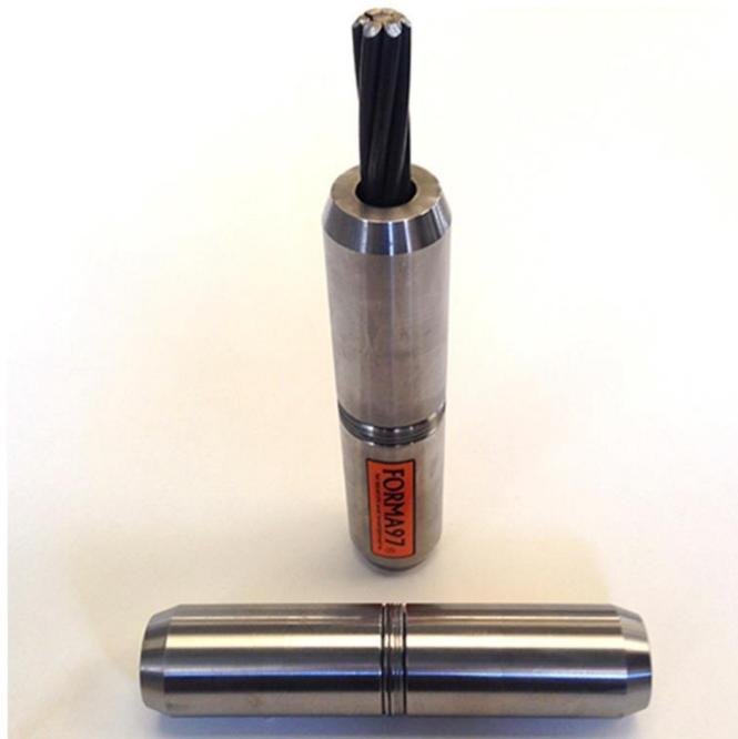
2.-Que se ha procedido a montar el conjunto con dos unidades de cordón de 15,2mm de diámetro de acero Y1860S7 sobre una bancada con una unidad de gato unifilar Paul 240kN.
